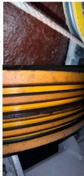
На правом фото показан износ тяговых канатов вследствие коррозии. Лифта № 4. Зап. № 174808
